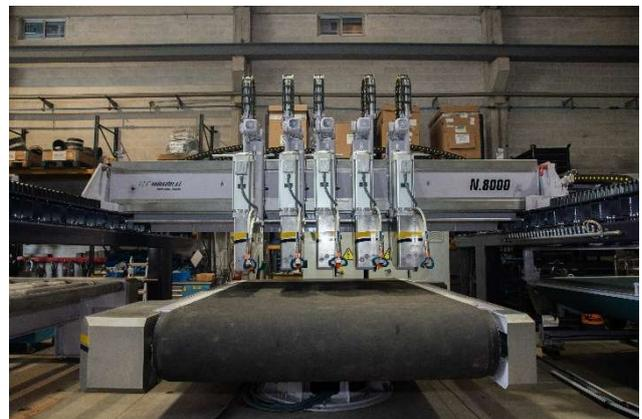
Incorpora freno hidráulico y unos potentes reductores sobredimensionados para las cargas y movimientos de las chapas
