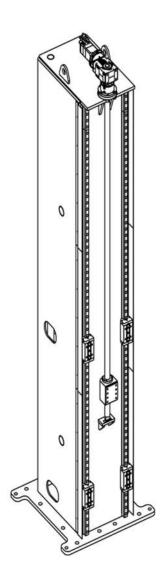
Fig. 1 – Detalle columna con guías lineales, patines, husillos movimiento vertical y servomotores
