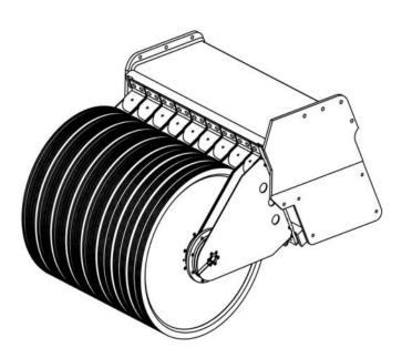
Fig.3 – Detalle conjunto de poleas locas desmontables con sistema de extracción pivotante
