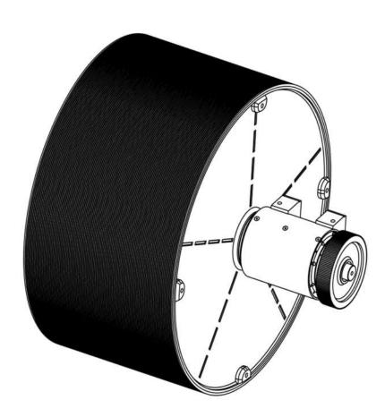
Fig. 4 - Detalle del conjunto tambor motriz, soporte y polea dentada
