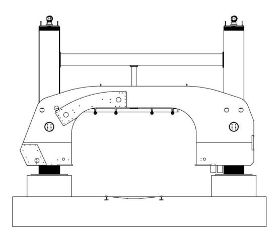
Fig. 5 - Detalle del bastidor principal, columnas y travesaño de unión
