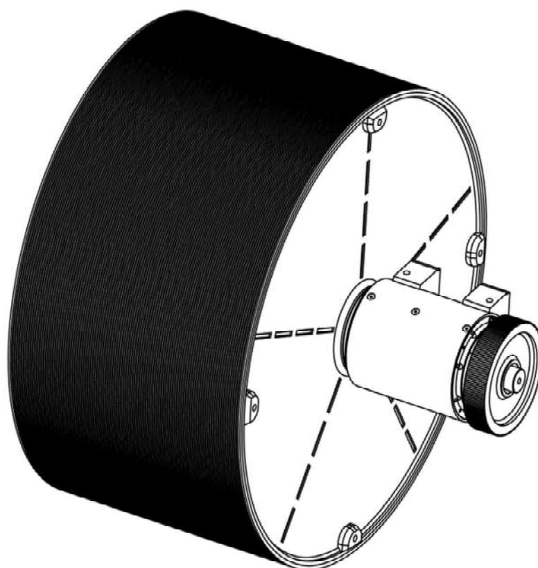
Fig. 4 - Detalle del conjunto tambor motriz, soporte y polea dentada
