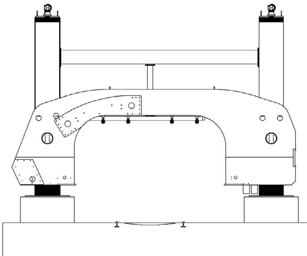
Fig. 5 - Detalle del bastidor principal, columnas y travesaño de unión
