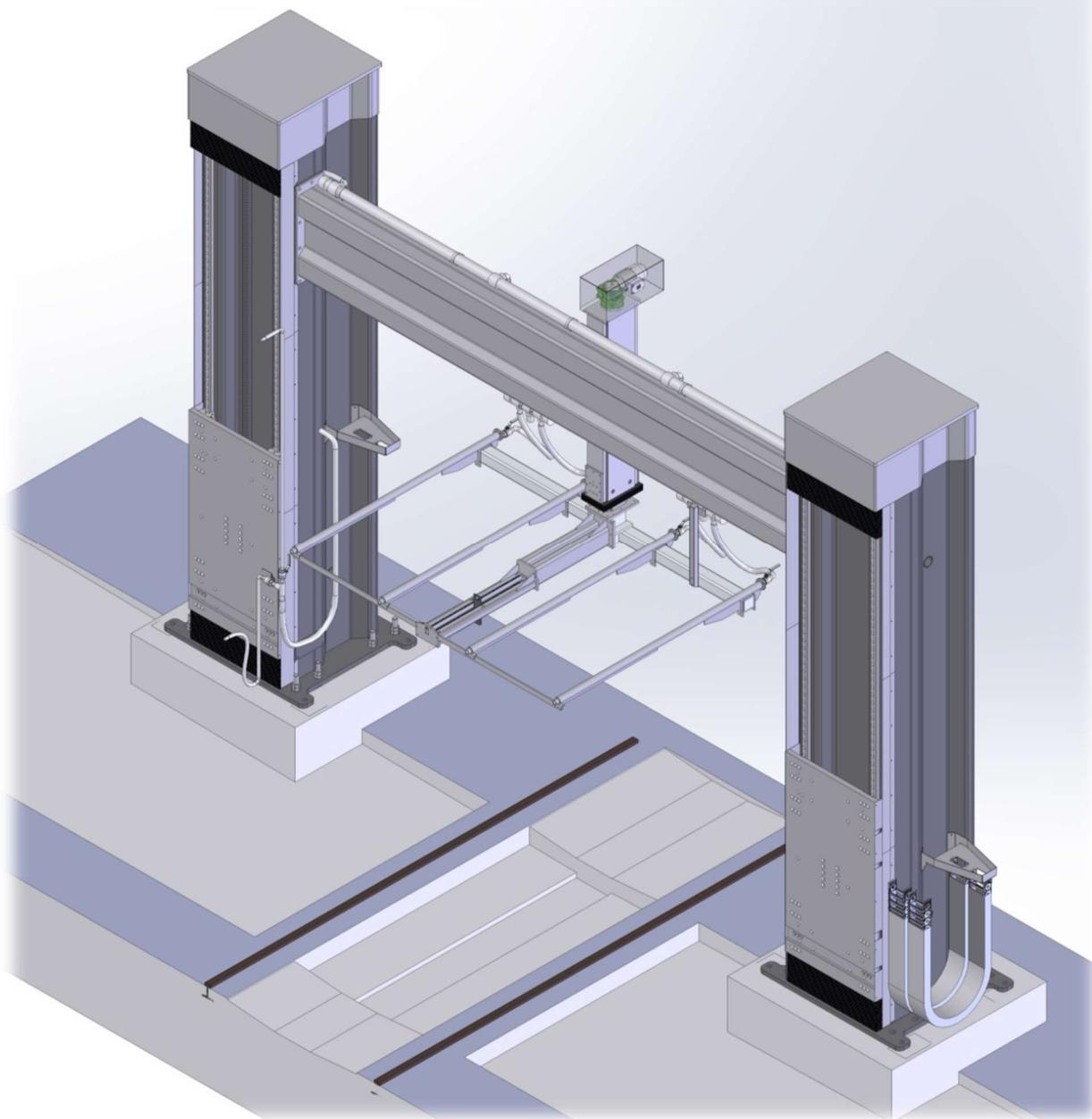
Fig. 1 – Detalle columnas con guías lineales, travesaños de unión y separador de chapas
