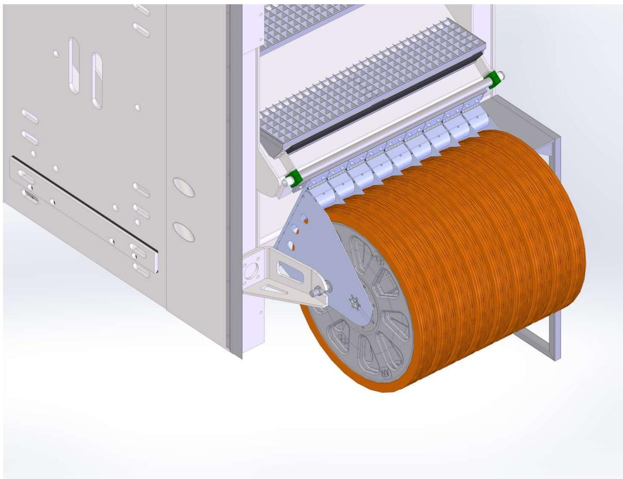
Fig.3 – Detalle conjunto de poleas locas desmontables con sistema de extracción pivotante
