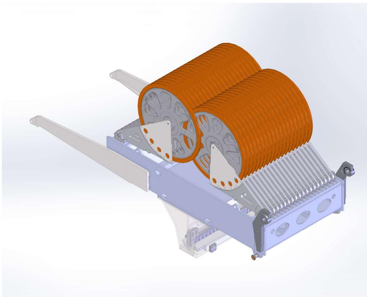
Fig.4 – Detalle del conjunto de poleas de tensado, sobre brazos articulados con cilindros tensores independientes
