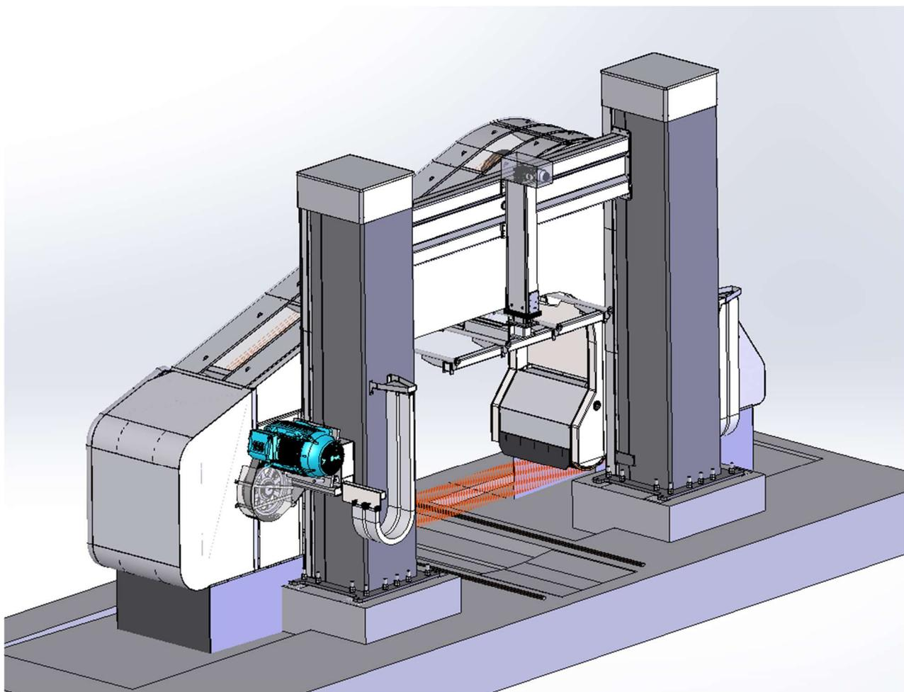
Fig. 6 - Detalle del bastidor principal, columnas y travesaño de unión
