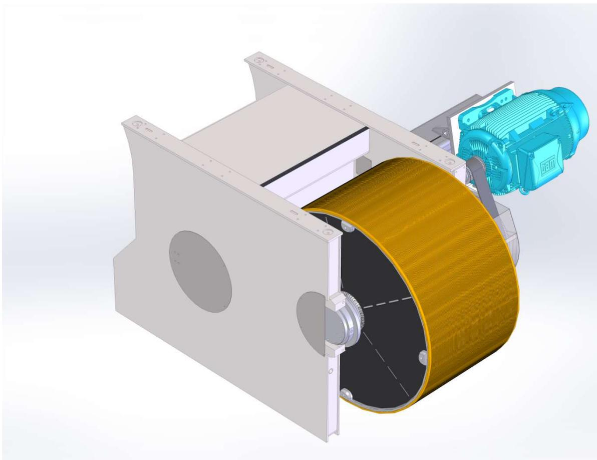
Fig. 2 - Detalle del conjunto tambor motriz, soportes y transmisión motor.
