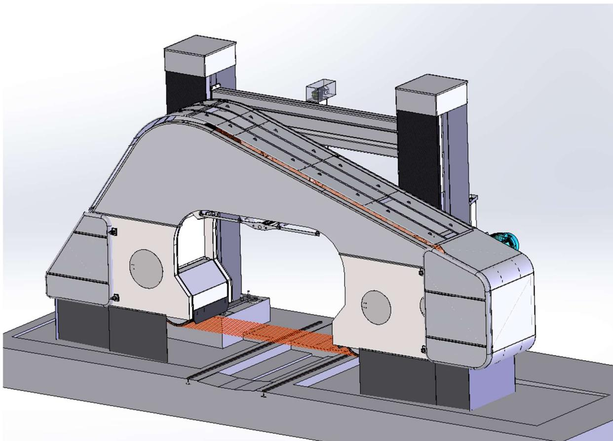
Fig. 5 - Detalle del bastidor principal, carcasa y protecciones.
